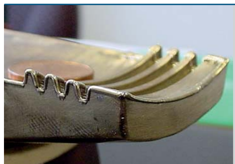
Wiederherstellung der verschlissenen Dichtkanten eines Formeinsatzes aus Ampco-Bronze (Foto: L&A Lasertechnik, Radebeul)
